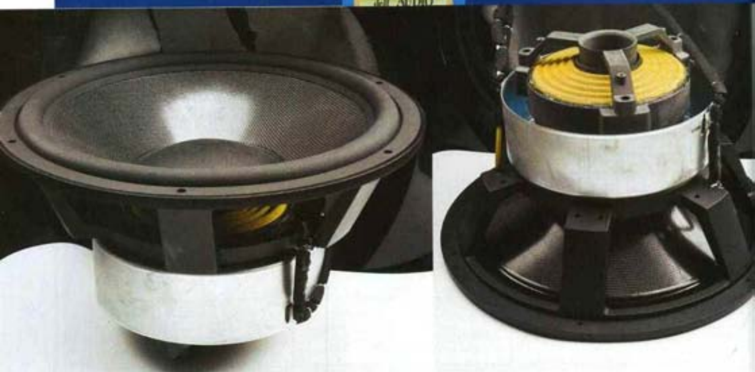
La parte posteriore del diciotto pollici per le basse più profonde evidenzia alcune delle peculiarità maggiori del driver Velodyne: doppio centratore, bobina e relativo supporto lunghissimi, struttura aperta del complesso motore per una migliore ventilazione, magneti potente e schermato, cestello pressofuso rigidissimo. Da notare i due fasci di cavi inguainati che veicolano da un lato il segnale di potenza e dall'altro quello destinato alla controreazione.
