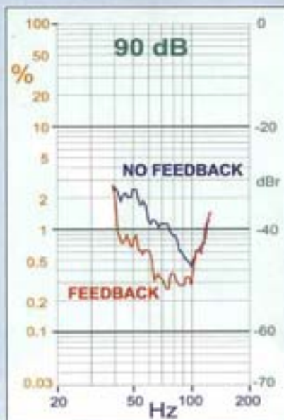
Figura 5. Total Noise Distortion a 90 dB di pressione, con (curva rossa) e senza (blu) controreazione.
